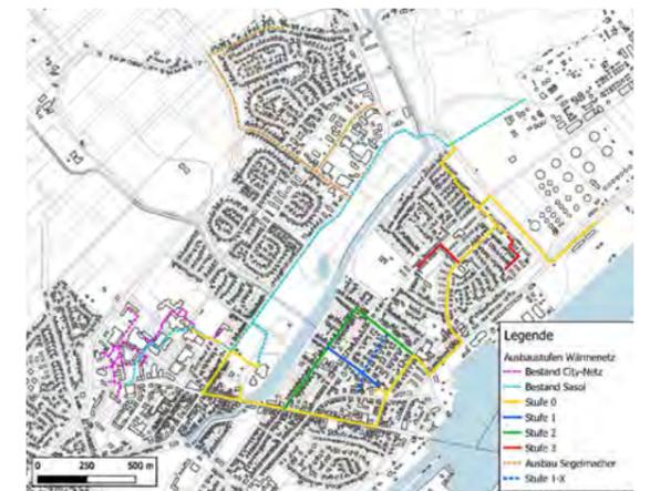
Ausbauetufen Wärmenetz © Averdung Ingenieure und Berater
